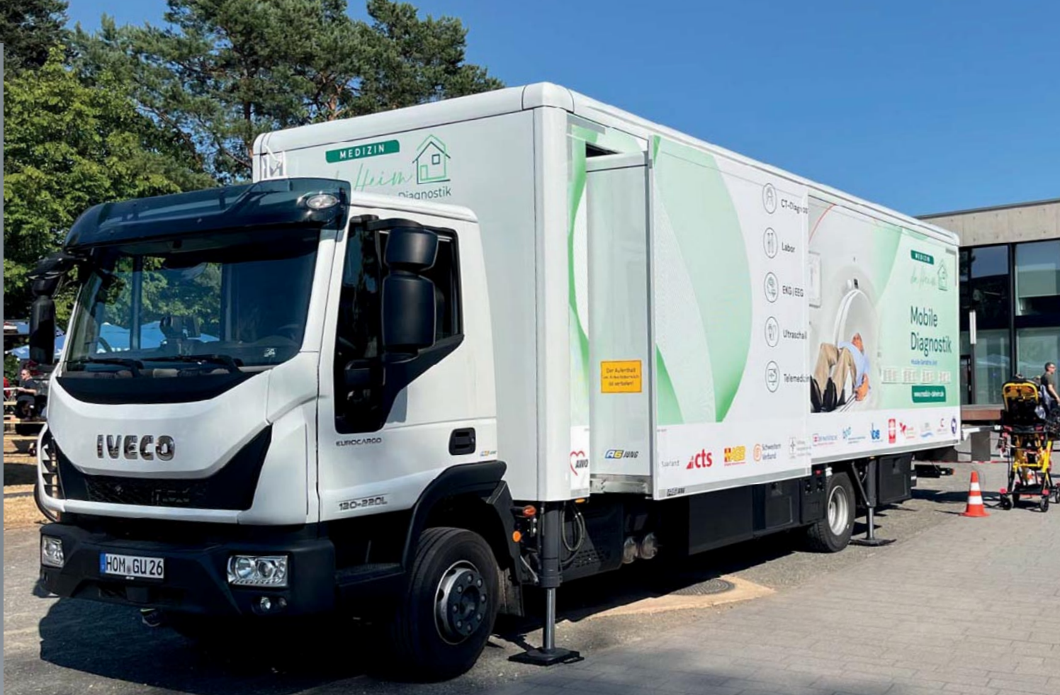
Fast 10 Meter lang ist der MGU-Truck und 2,60 Meter breit, ganze 3,70 Meter hoch und 12 Tonnen schwer. In seinem Inneren findet sich alles, was in eine klinische Notaufnahme gehört: Computertomograph, Sonografie-, Röntgen- und Ultraschallgeräte, EEG, EKG und eine Laborausstattung.
